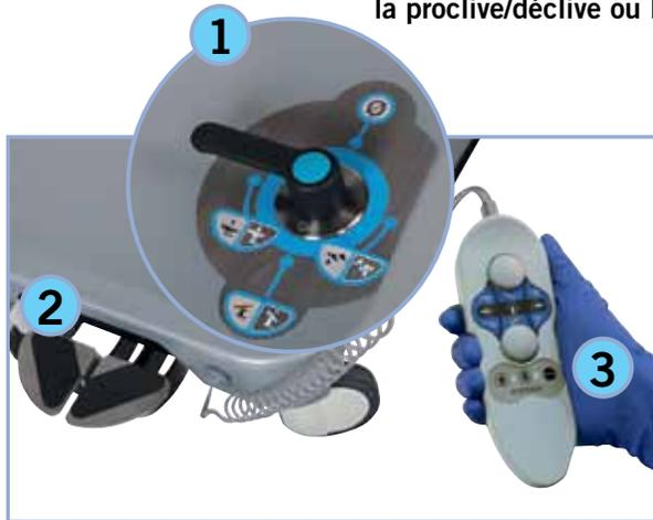
Le sélecteur permet le réglage de la hauteur, la proclive/déclive ou l'inclinaison latérale.
